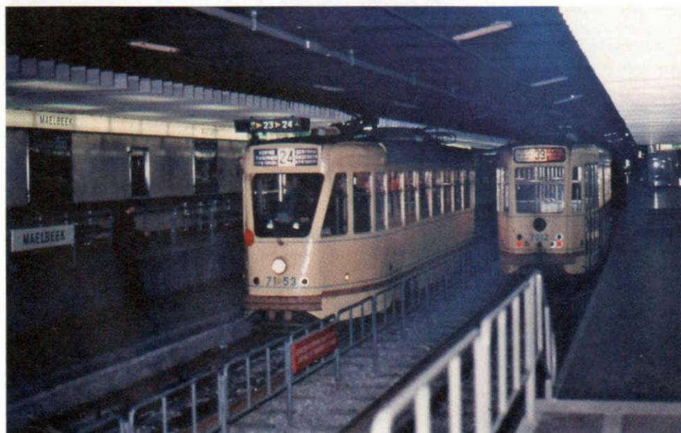
Les 7000, équipées du mode de captation par pantographe, sont ainsi les premières motrices à circuler dans les tunnels de pré-métro aussi bien de l'axe Est-Ouest que de la Petite Ceinture. La 7153 de la ligne 24 croise la 7012 de la ligne 39 à la station Maelbeek. © auteur inconnu.
