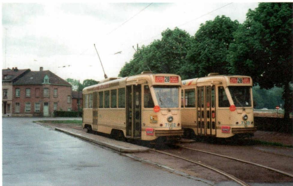
A la fin des années 1960, les 7000 sont équipées pour permettre leur circulation en toute sécurité dans les tunnels de pré-métro et sont identifiées par l'apposition d'un « M » sous le matricule avant et arrière. Cet identifiant se muera en « T » quelques mois après pour disparaître après quelques années. Place Saint-Lambert à Woluwe Saint-Lambert, le 18.05.1969. © R.Bastaens.
