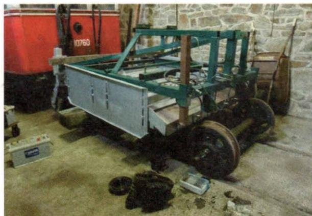
Le nouvel équipement de désherbage thermique en cours de montage sur un wagonnet. Blier, 16.01.2010 © A. Corteil
